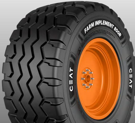
Les pneus radiaux **800R** à ceintures en acier sont conçus pour une protection optimisée du sol et des plantes, adaptés à diverses applications, notamment le transport, le pressage et le travail du sol.
