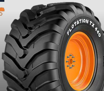
Volume et empreinte plus importants du pneu **FLOTATION TX440** pour augmenter le contact au sol, réduisant la compaction du sol.
