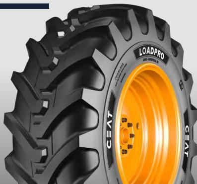
Le **LOADPRO** existe en version radiale et diagonale, est un pneu conçu pour les télescopiques à usage intensif avec des caractéristiques qui renforcent et protègent le pneu contre les dommages.
